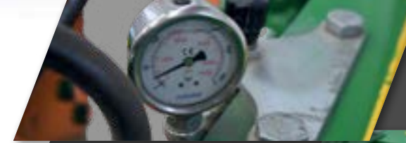
Hidrolik olarak ayarlanabilir sertlik mekanizması
