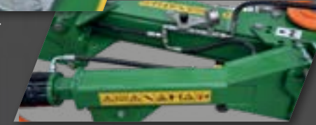
Hidrolik piston mekanizması ile kesintisiz sürüm
